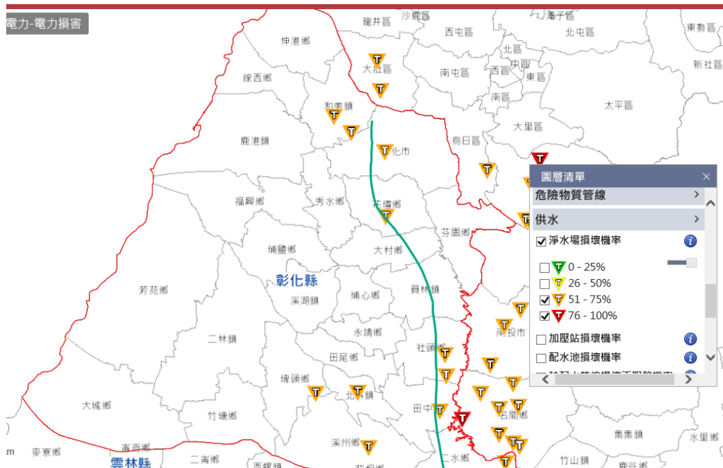
圖1-3-10模擬淨水廠損壞機率
